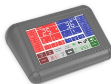
Art.308-01 Console-700, console multisport con display touchscreen 7 Dimensioni: 24.5x17x8.5cm. - Peso: 1.35kg.
