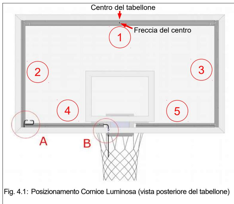
Fig. 4.1: Posizionamento Cornice Luminosa (vista posteriore del tabellone)
