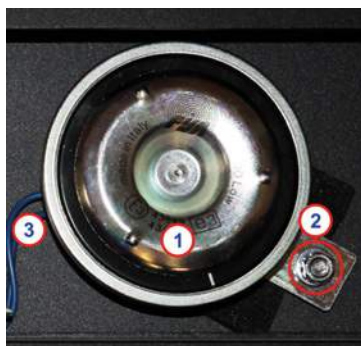
Fig. 11 Cambio de la bocina
