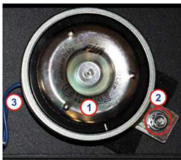
Fig. 11 Sostituzione del clacson.
