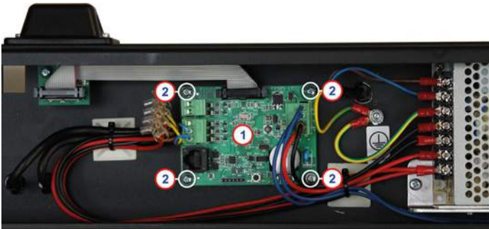
Fig. 8 Remplacement d'une carte FC HUB.
