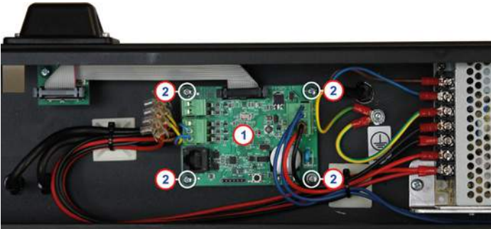
Fig. 8 Sostituzione di una scheda FC HUB.
