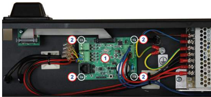
Fig. 8 Cambio de la tarjeta FC HUB.
