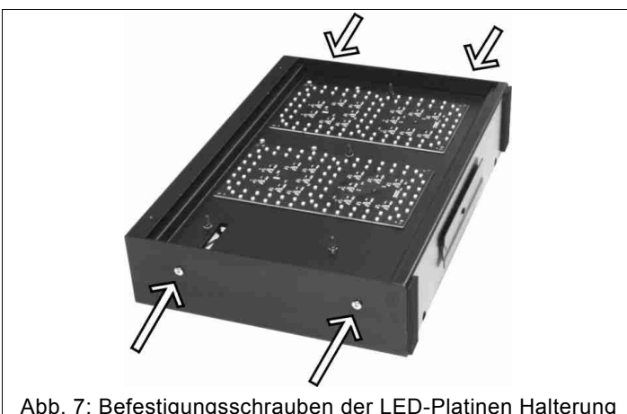
Abb. 7: Befestigungsschrauben der LED-Platinen Halterung
