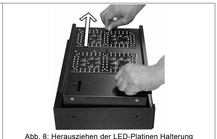
Abb. 8: Herausziehen der LED-Platinen Halterung
