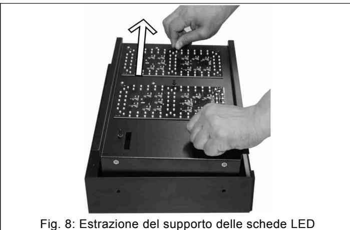
Fig. 8: Estrazione del supporto delle schede LED
