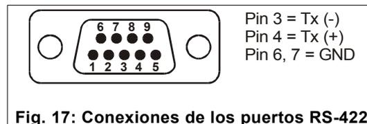
**Fig. 17: Conexiones de los puertos RS-422**
