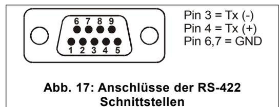
Abb. 17: Anschlüsse der RS-422 Schnittstellen
