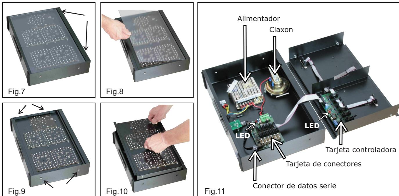
**4.3 Cambio de una tarjeta de visualización de LEDs**
