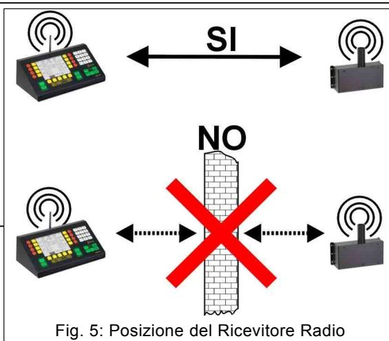
Fig. 5: Posizione del Ricevitore Radio
